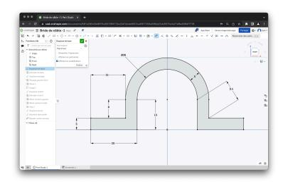
Cette fonction permet d'imposer des contraintes pour garantir la position et l'interaction entre les éléments de dessin d'une esquisse
